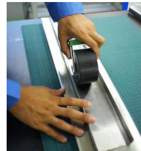
3. 剥去离型纸，与其他材料用压辊等充分压合。
